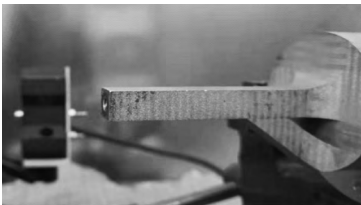
图 16 连接刀具前变幅杆结构
